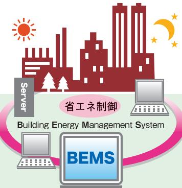
ビルエネルギー管理システム(BEMS)は、ビルや工場といったエネルギーを消費する設備におけるエネルギーの使用状況を一元的に把握し、需要予測に応じて省エネを実現するために最適なエネルギー消費計画を立案し実行するシステムである。
