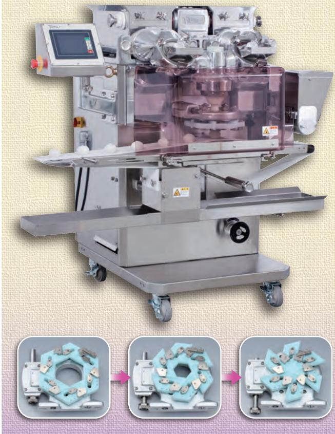
に、隣接するシャッタと接しながら軸に對して水平方向に動く、一つの動きを実現している。シャッタ片の先端の摩耗を大幅に減らし、美しい包あん機能をより長期にわたって維持できるようになった。
