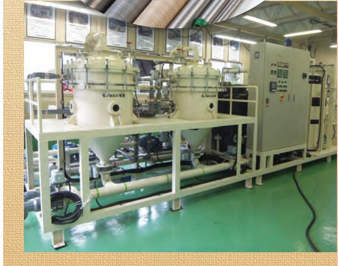
い採用実績がある。海水の淡水化施設では浮遊物質除去の前処理に利用され、塩分を除去するRO膜の長寿命化に貢献している。また研磨廃水から研磨液、メキシ処理液などを回収・再生するシステムもある。いずれも運用コスト、廃棄物処理コストを大幅に低減する成果を生んでいる。
